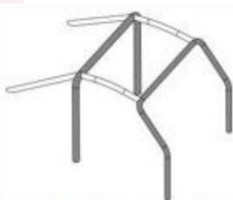
1 főbukócső 1 mellső bukócső 2 hosszanti merevítő 2 hátsó megtámasztás
